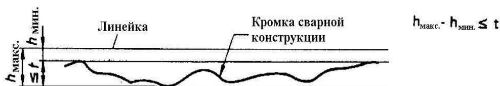
Рисунок 6. Испытание на прямызна
