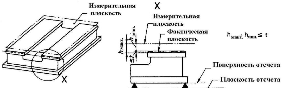
Рисунок 8. Тест на параллельность
