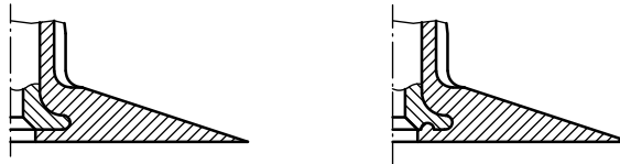
b) Optional head shapes b) Formes optionnelles de pied de valve
