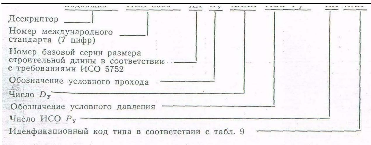
Пример: задвижка, с маховиком, серия 15 размеров строительных длин, Ду 500, ИСО Р<sub>y</sub> 10, с невыдвижным шпинделем (обозначение М), все внутренние детали из чугуна (обозначение О), чугун с шаровидным графитом (обозначение 2), тип запорного элемента
