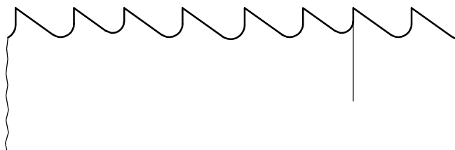
Figure 10 — Variable pitch tooth Figure 10 — Denture à pas variable
