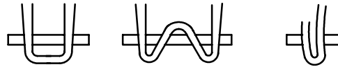
Figure 27 — Examples of “U” tuft, “W” tuft and “J” tuft Figure 27 — Exemples de touffes en «U», en «W» et en «J»
