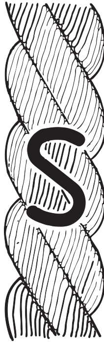
Figure 3: "S" lay or "S" twist or left hand lay Bild 3: "S"-Drehung oder "S"-Schlag order Linksschlag Figure 3: Torsion "S" ou torsion gauche
