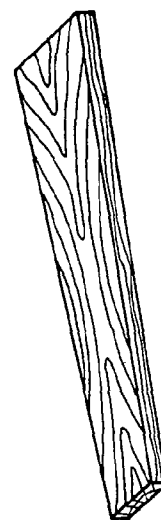
FIG. 2 — Square-edged sawn timber with tapered edges FIG. 2 — Bois scié avivé à rives non parallèles Рис. 2 — Обрезной пиломатериал с непараллельными кромками
