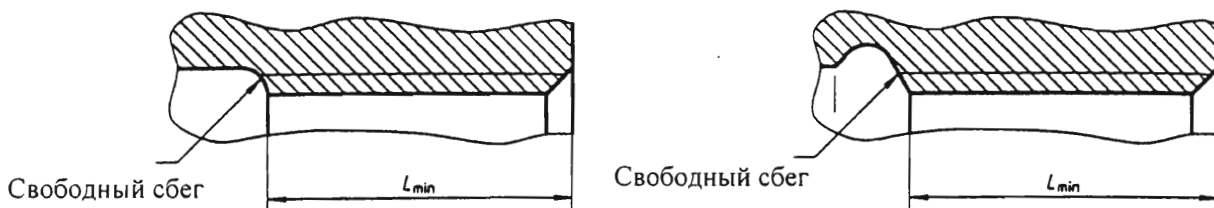
Рис.4. Внутренняя резьба со свободным сбе́гом
