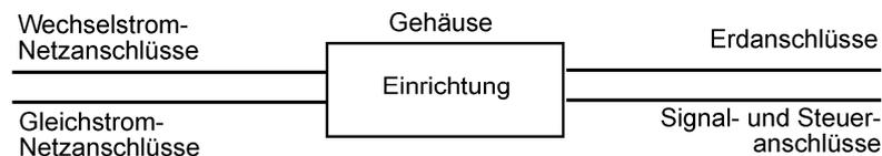
**Bild 1 – Beispiele von Anschlüssen (Toren)**
