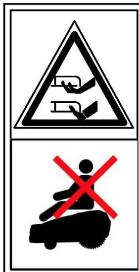
**Bild EE.5 – Bildzeichen, das den Warnhinweis „Nicht auf der Maschine mitfahren!“ veranschaulicht**
