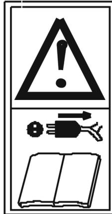
Bild AA.2 – ABSCHALTEN: Netzstecker ziehen vor Reinigungs- und Instandhaltungsarbeiten
