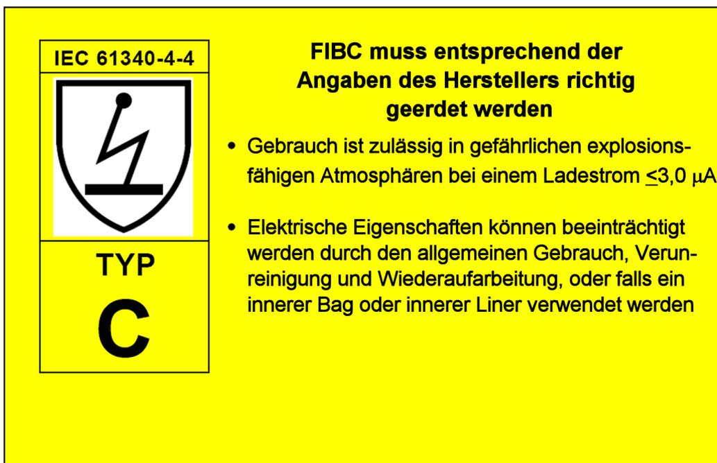
Bild 2 – Beispiel einer Kennzeichnung für FIBC Typ C
