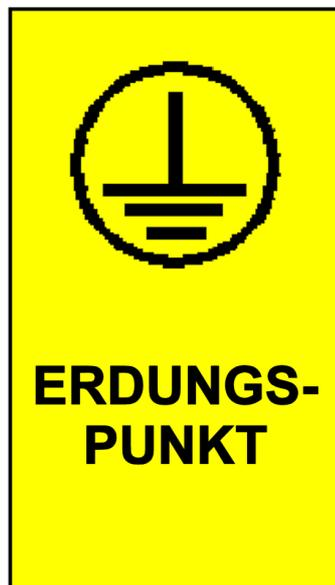
Bild 4 – Beispiel einer Kennzeichnung für gekennzeichnete Erdungspunkte des FIBC Typ C
