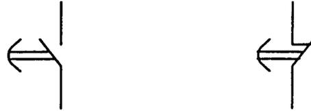
Bild 7 – Graphische Symbole, die eine Verzögerung kennzeichnen
