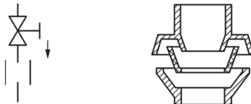
Bild B.1 — Sicherungsarmatur Familie D, Typ C und Konstruktionsprinzip
