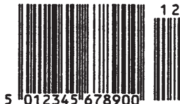
Bild 5: "EAN-13" Strichcodesymbol mit zweistelligem Zusatzsymbol
