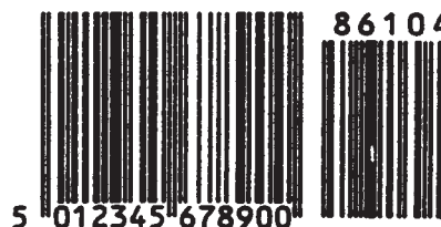
Bild 6: "EAN-13" Strichcodesymbol mit fünfstelligem Zusatzsymbol
