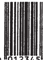
Bild 4: "UPC-E" Strichcode (Verschlüsselung von 0-01234-00005-7 mit Nullenunterdrückung)
