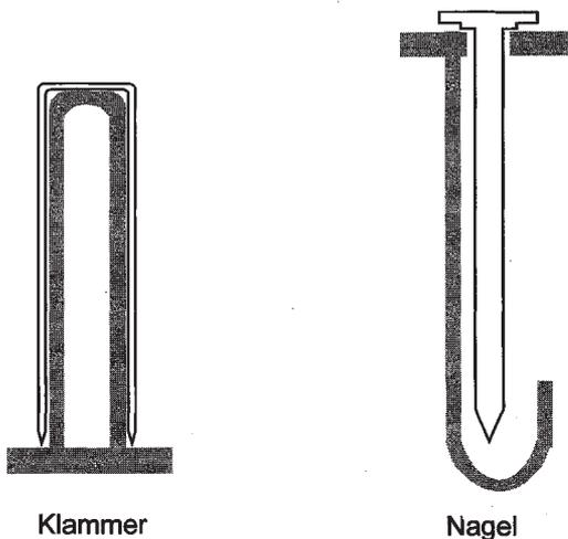
Bild 3: Beispiel für Schutzabdeckungen des Magazins (Schnitt)
