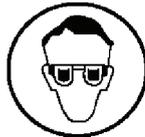
**H.8 Bildzeichen, das anzeigt, dass der Kolben der (Entladungs-)Lampe während des Betriebs UV-Strahlung aussendet**
