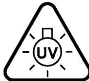
**H.9 Bildzeichen, das anzeigt, dass die Lampe nur in einer Leuchte mit einer Schutzabdeckung betrieben werden darf**
