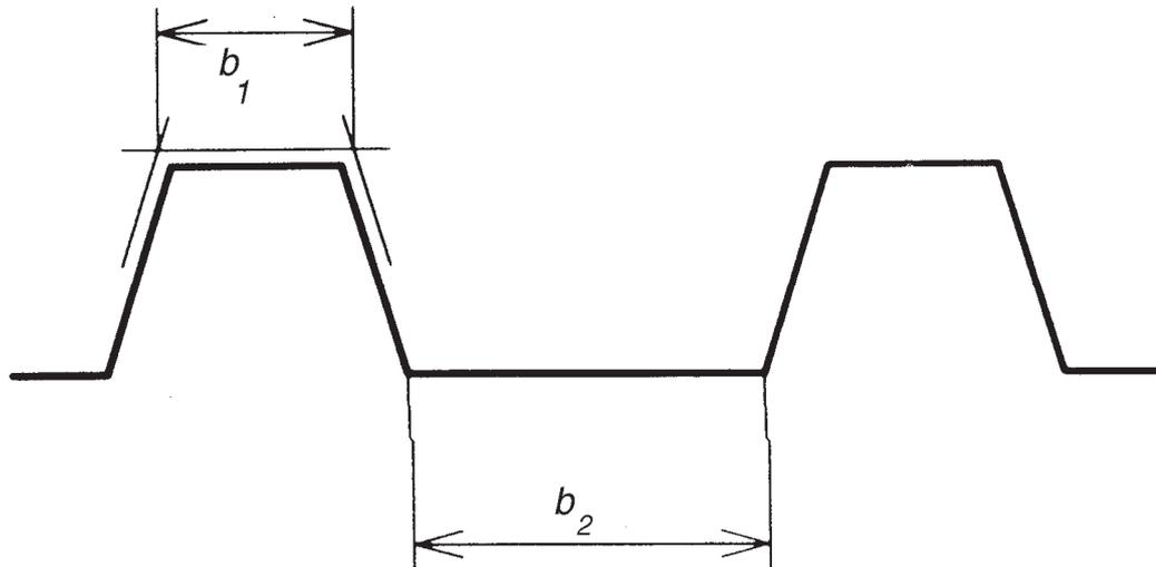
Bild B.3 — Breite des Ober- und Untergurtes
