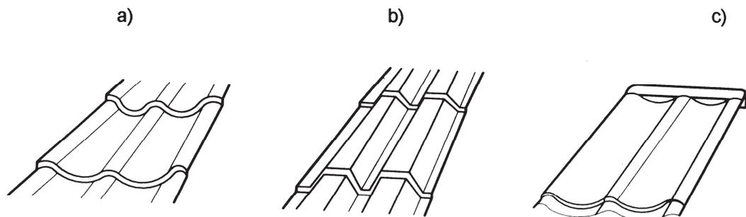
**Bild 9 — Typische Dachpfannenprofile**
