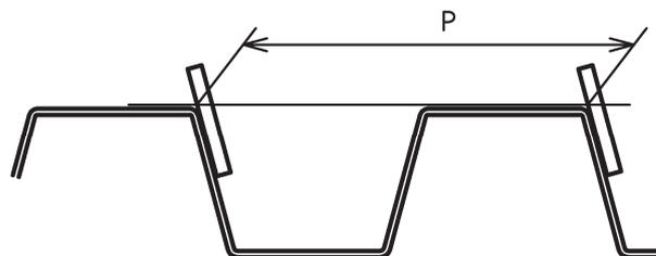
**Bild B.21 — Maßprüfung für Profilbreite**
