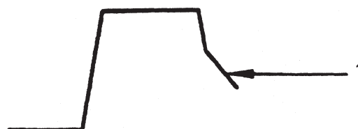
Bild B.26: Längsüberlappung mit Versteifungskantung
