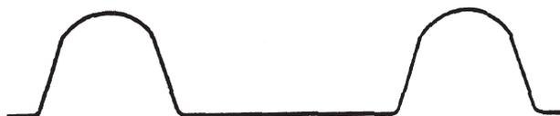
Bild 3: Querschnitt eines typischen Trapezprofils mit gerundetem Obergurt
