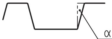
Bild A.12 — Stegverschiebung
