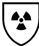
Bild 3 — Piktogramm ISO 7000 – 2809 Schutz gegen ionisierende Strahlung
