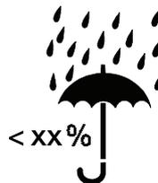
**Bild 12d – Maximale relative Feuchte der Lagerbedingungen**
