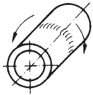
PG Rohr: fest Achse: waagrecht Schweißung: fallend
