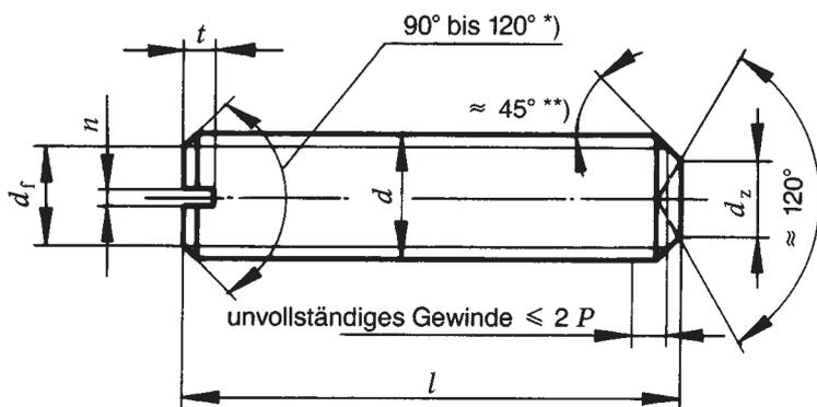
\*) Der Winkel 120° gilt für kurze Gewindestifte oberhalb der gestrichelten Stufenlinie.
