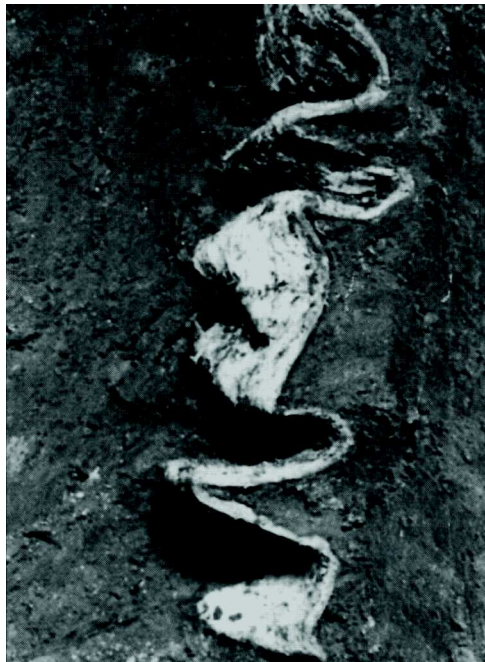
Bild A.5 — Ausknicken und Kräuseln des Drängs durch sehr starke relative Kompression von Torf
