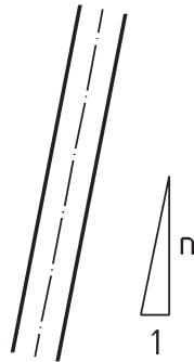
Bild 2 — Definition der Neigung von Mikropfählen
