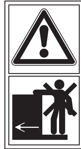
Bild B.3 — Das Besteigen der Maschine während des Betriebes ist gefährlich
