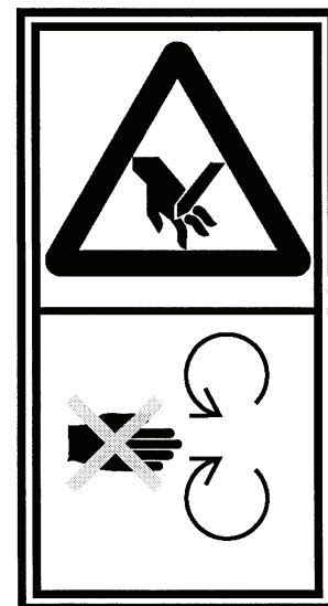
Bild E.2 — „Achtung vor rotierenden Messern. Hände und Füße nicht in Öffnungen halten, wenn die Maschine läuft“
