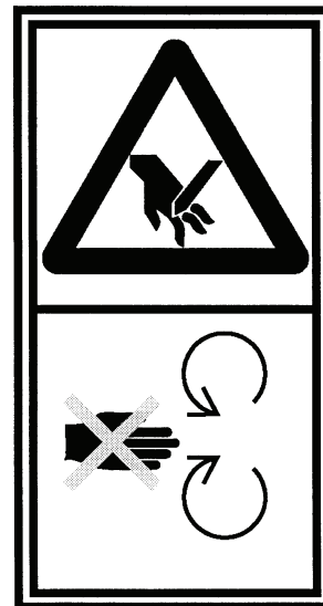
Bild E.2 — „Achtung vor rotierenden Messern. Hände und Füße nicht in Öffnungen halten, wenn die Maschine läuft“
