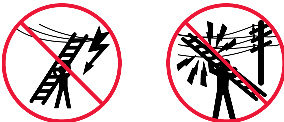
Bild A.15 — Beim Transport der Leiter auf Gefährdung durch Stromleitungen achten
