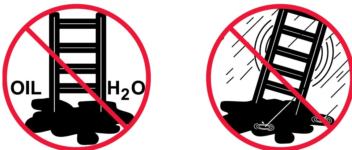
Bild A.6 — Verunreinigungen auf dem Boden meiden
