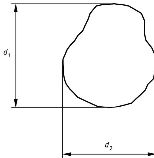
**Bild 4 — Messung des Ausbreitmaßes**
