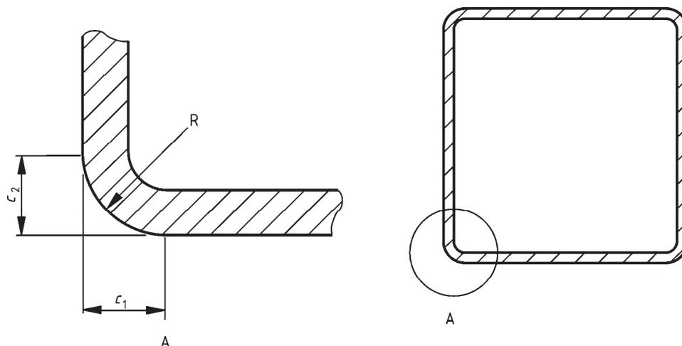
**Bild 4 — Äußeres Rundungsprofil von Hohlprofilen mit quadratischem oder rechteckigem Querschnitt**
