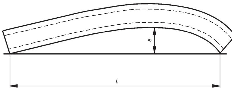
**Bild 8 — Messung der Abweichung von der Geradheit**
