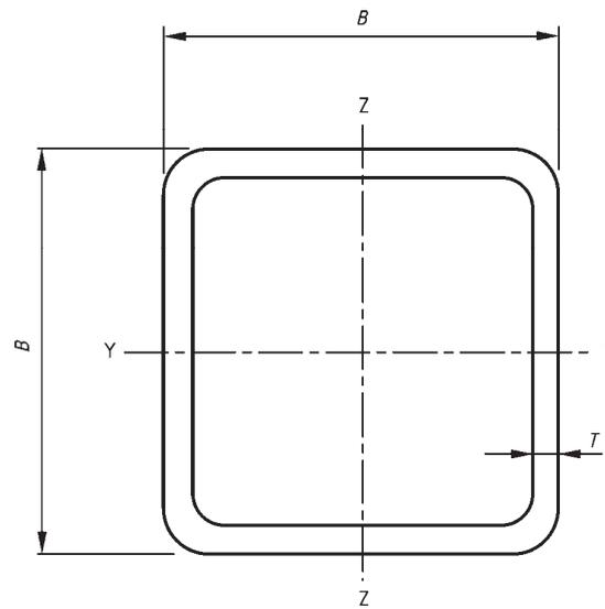
**Bild B.2 — Hohlprofil mit quadratischem Querschnitt**
