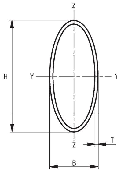
Bild B.4 — Hohlprofil mit elliptischem Querschnitt
