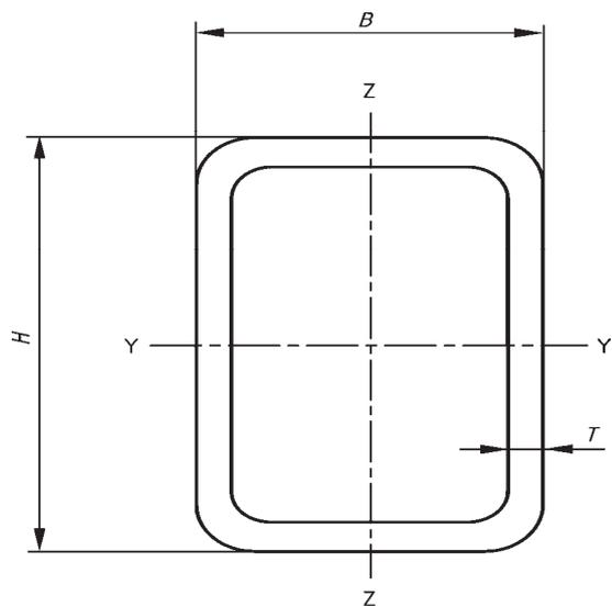
Bild B.3 — Hohlprofil mit rechteckigem Querschnitt
