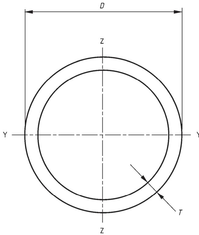
**Bild B.1 — Hohlprofil mit kreisförmigem Querschnitt**
