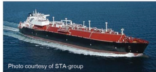
g) LNG carrier prismatic extended deck
