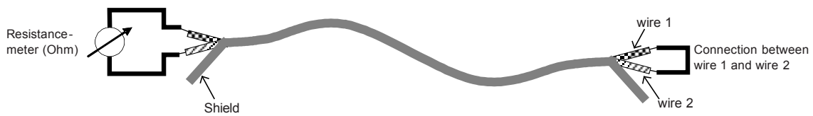
Figure N.1 – Loop resistance measurement wire to wire
