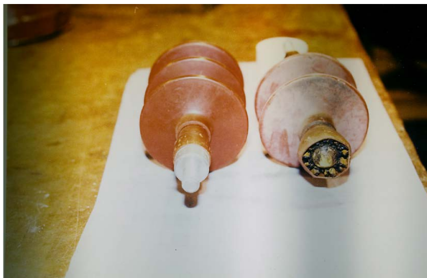
Figure A.51 – Barre excessivement pincée – Se brise au cours de l'essai de traction
