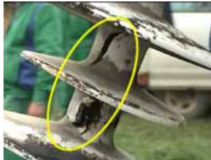
Figure A.29 – Isolation externe défailante – Exemple 2
