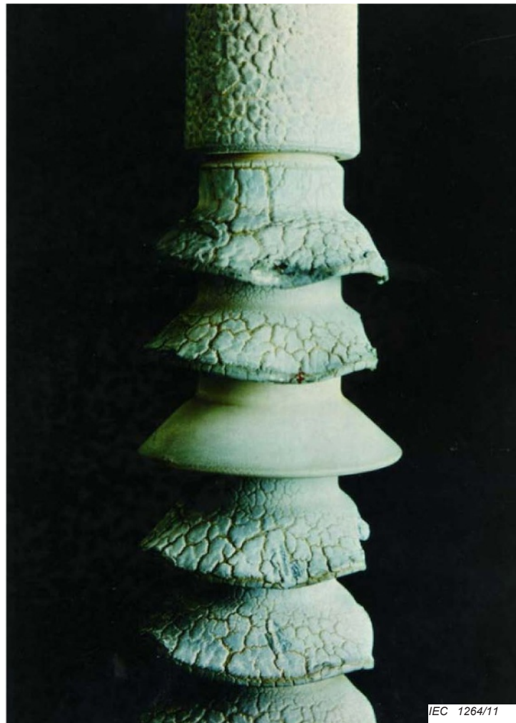
Figure A.27 – Calcination d'EPDM et érosion sur raccord
