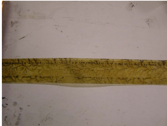
Figure A.20 – Isolation en papier dégradée par les décharges superficielles électriques
