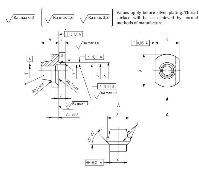
Remove sharp edges 0,1 mm to 0,4 mm
