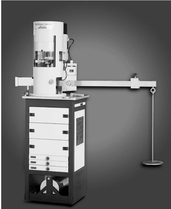
Fig. 17—Four-Ball Tester (ASTM D2266, D2596).
