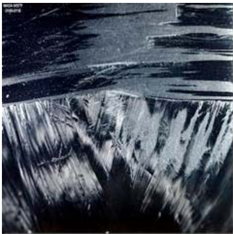
FIG. 30 Level I Abrasion
