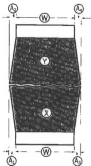
РИС. 6 Половинки разломанного образца с V-образным надрезом для испытания по Шарпи, иллюстрирующие измерение расширения в поперечном направлении, размеры A_1 , A_2 , A_3 , A_4 и первоначальную ширину, размер W
