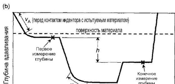
**Рис. 2 Схематические диаграммы "усилие – время" (а) и "глубина индентора – время" (b) испытания HRC, демонстрирующие части цикла испытаний**
