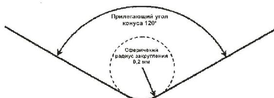
**РИС. А3.1 Схема поперечного сечения вершины сфероконического алмазного индентора**
