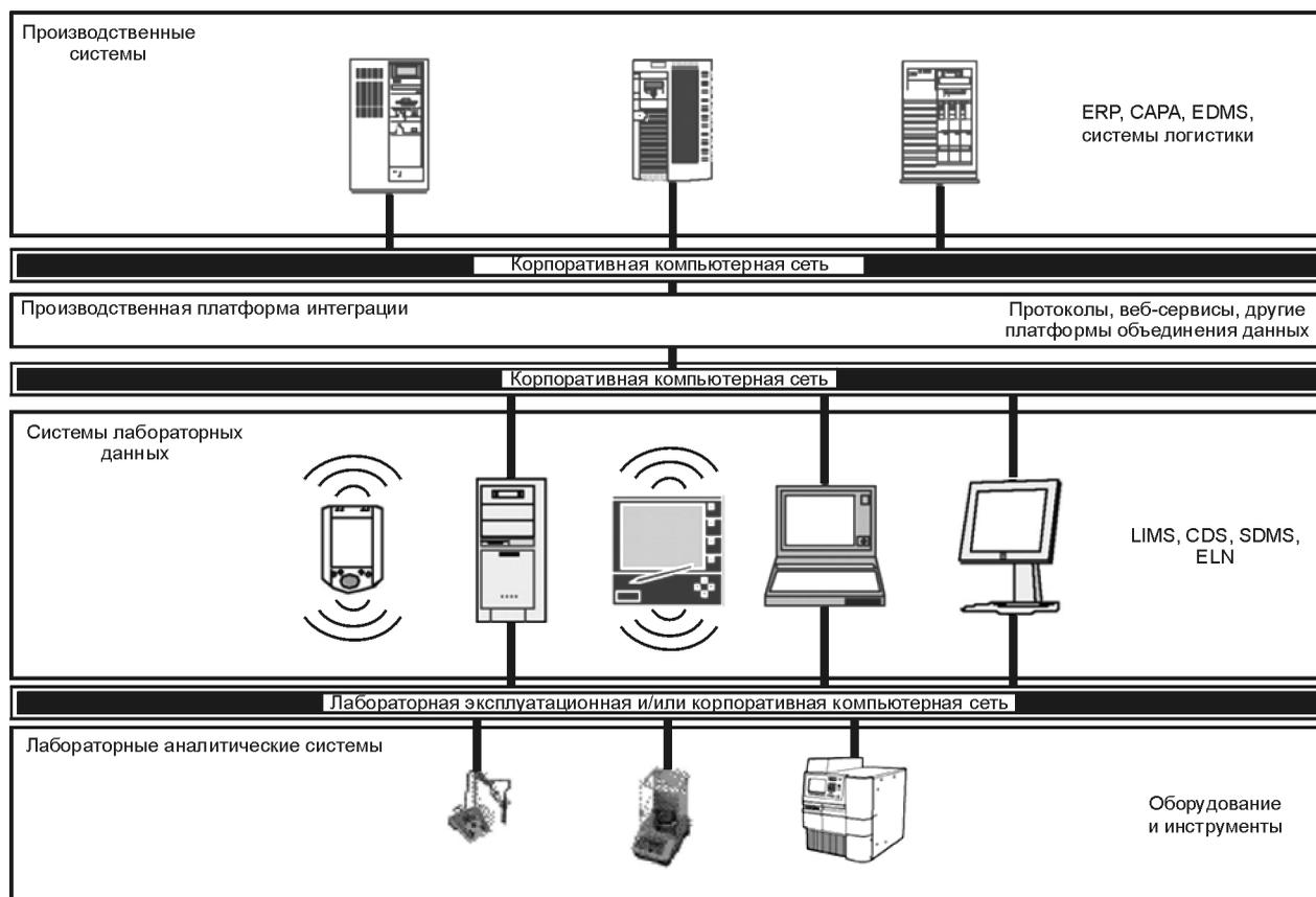
Рисунок 6 — Концептуальная лабораторная информатика и корпоративная компьютерная архитектура
