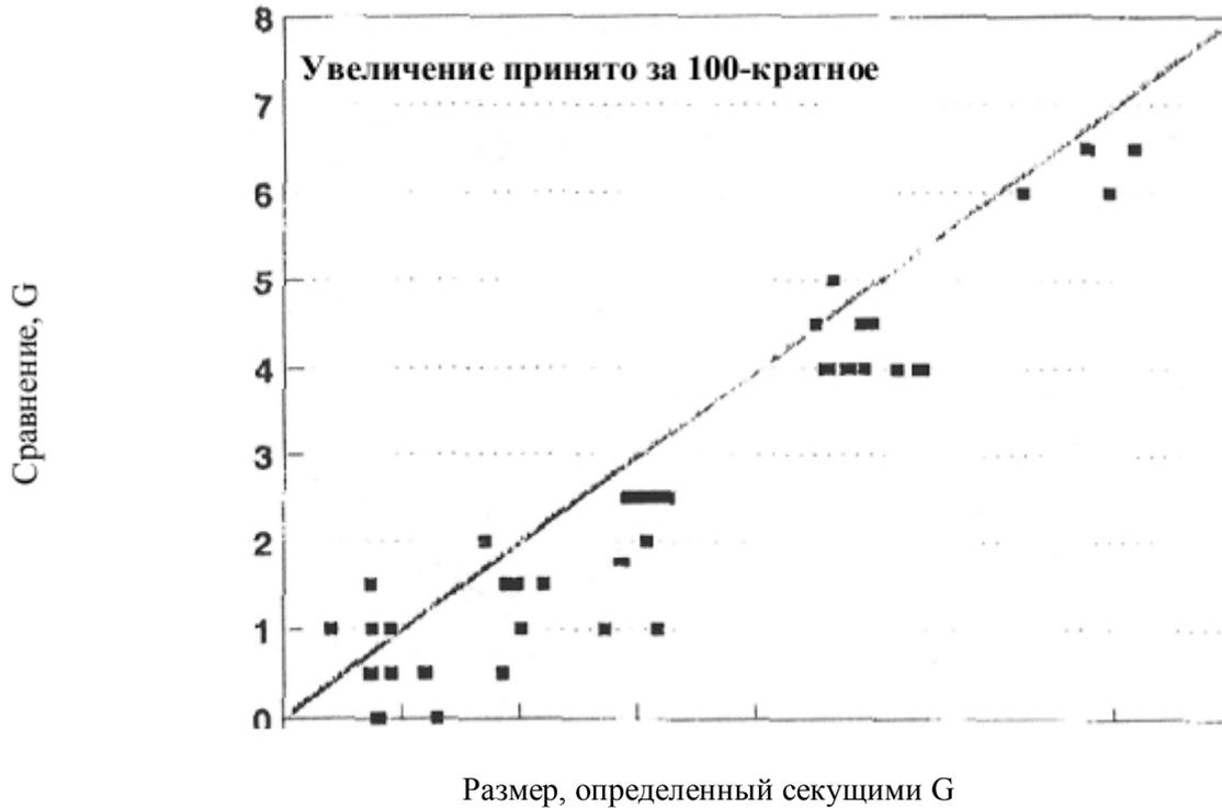
**РИС. X1.7** Диаграмма оценок размера зерна по сравнительной карте для каждого микроснимка по сравнению с оценкой методом секущих для каждого микроснимка
