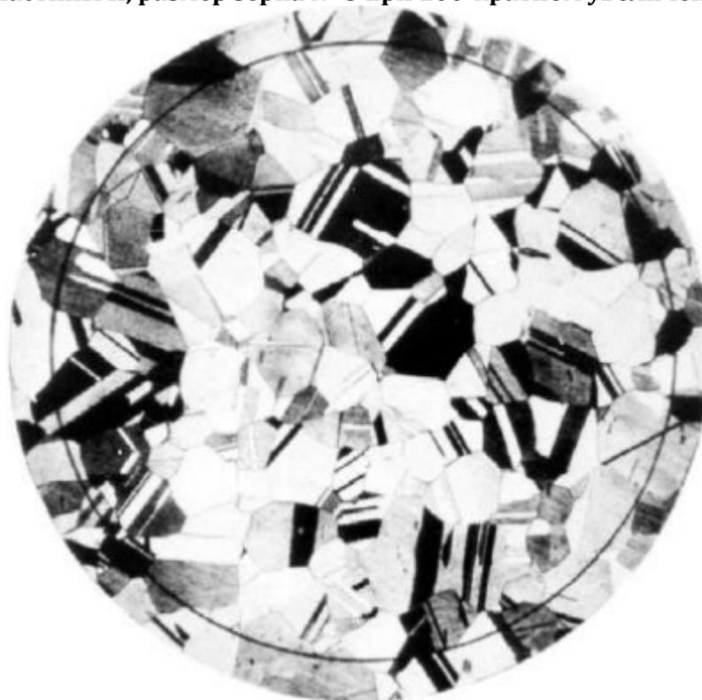
**РИС. 3** Пример двойниковых зерен (контрастное травление) из Пластины III, размер зерна 0,090 мм при 75-кратном увеличении.
