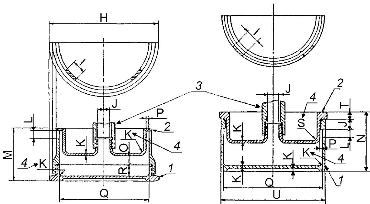
a) Чашка для образца пластичной смазки
