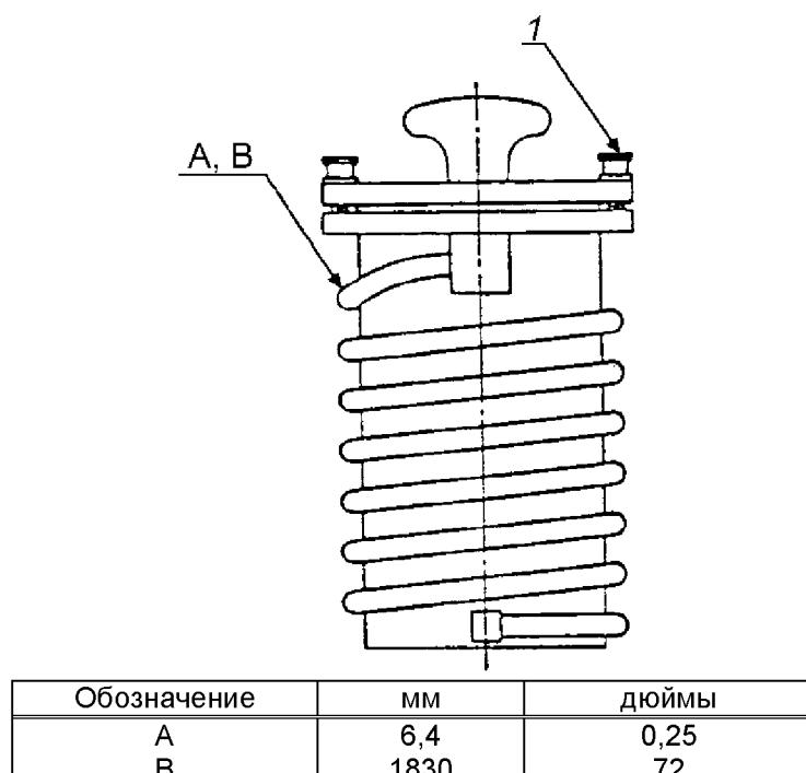
А - наружный диаметр трубы; В - длина трубы не менее 7 витков, 1 – винты для затягивания крышки
