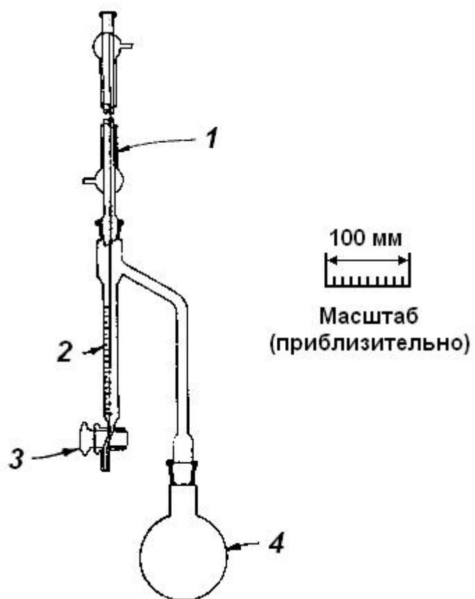
1 – холодильник; 2 – приемник; 3 – запорный кран; 4 – стеклянный перегонный куб
