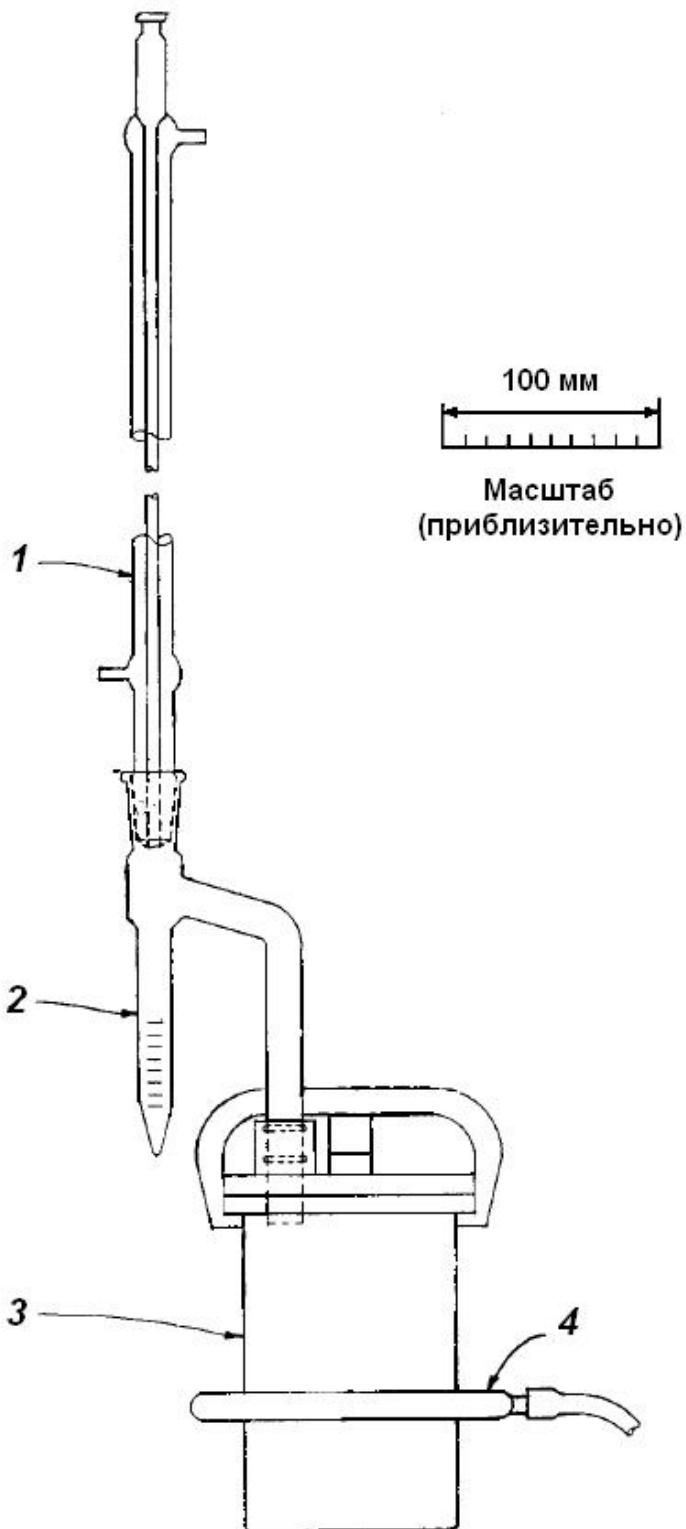
1 – холодильник; 2 – приемник; 3 – металлический перегонный куб; 4 – кольцевая горелка
