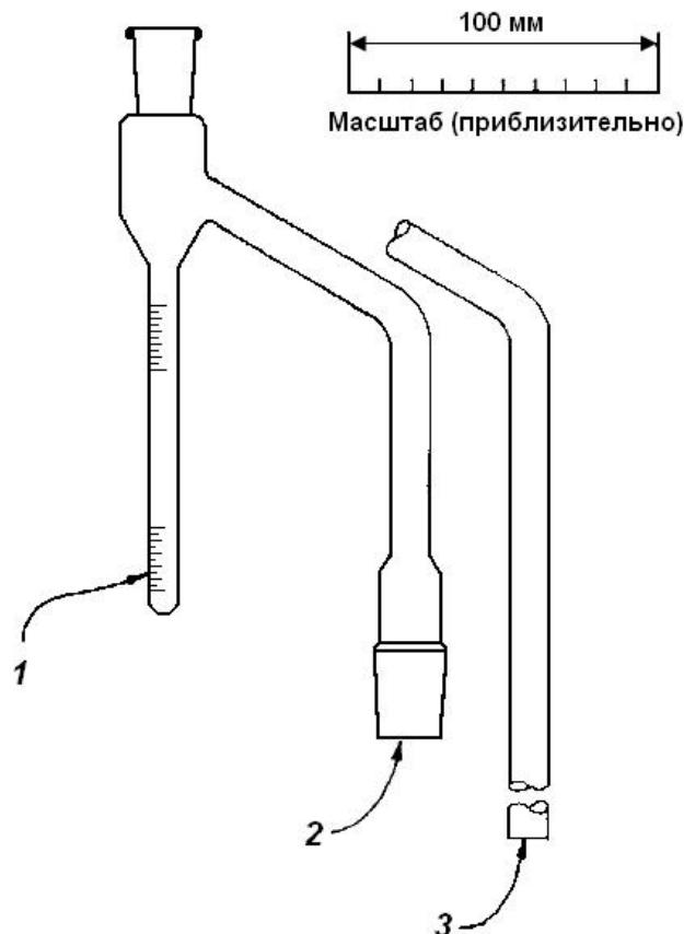
1 – интервал градуировки – 0,05 см<sup>3</sup>; 2 – конусное соединение; 3 – простое соединение
