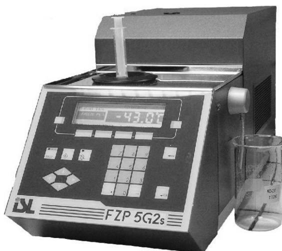
Рисунок А1.4 — Аппарат для автоматического определения температуры замерзания
