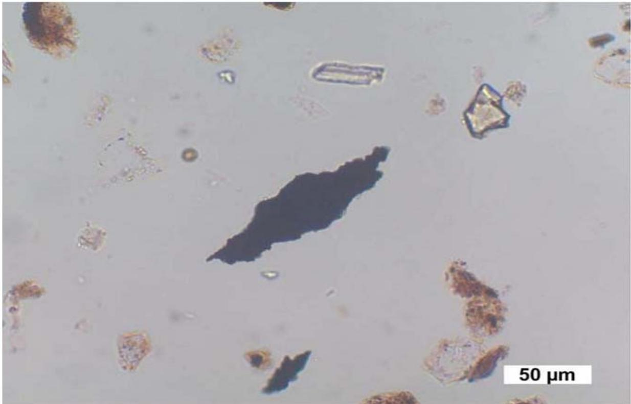
**Рисунок А.1.6 – Микроснимок частиц резины (отбор проб при использовании жидкости 1.55 RI Cargille), полученный с помощью PLM в проходящем свете**
