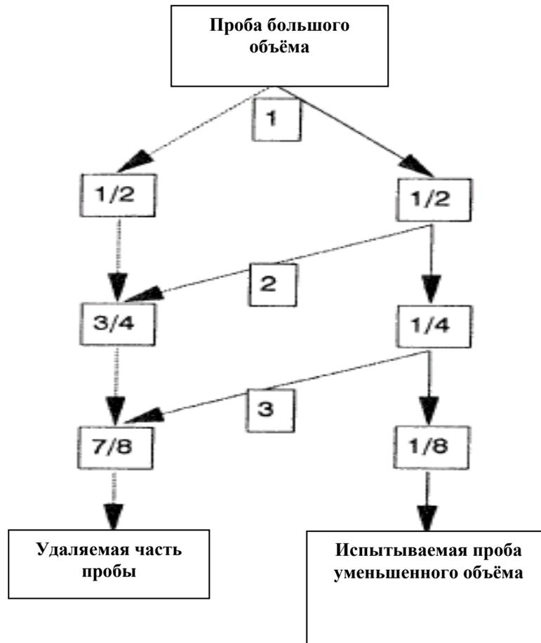
Рисунок 2 - Уменьшение объёма пробы
