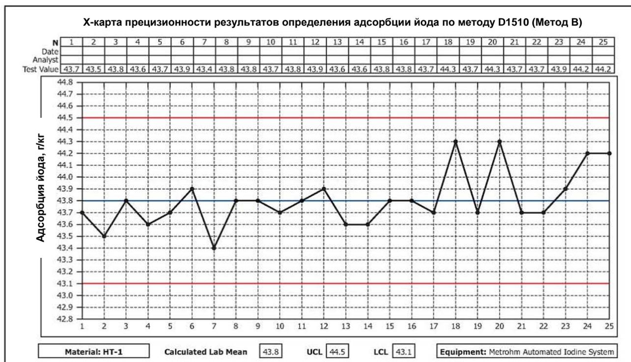
**Рисунок 2 – Х-карта прецизионности результатов определения адсорбции йода эталонного технического углерода HT-1, подготовленная при использовании вычисленного внутрилабораторного среднего значения и пределов регулирования, указанных в Руководстве стандарта D4821**
