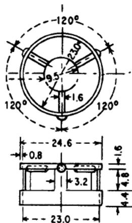
б - Направляющее устройство для центрирования шариков
